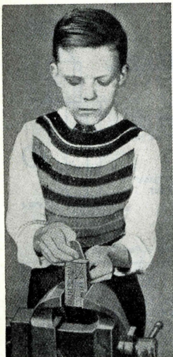
C - PER PIEGAR BENE la mensola della bobina occorre usare l'apposita forma.
